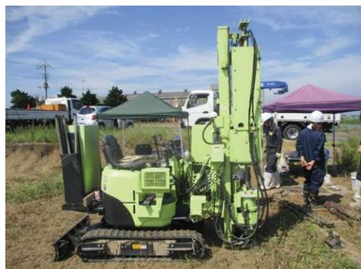
全自動式大型動的コーン貫入試験機
